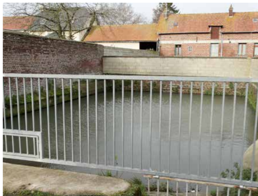
Mare rue Principale (entre le n°9 et le n°11) servant pour la défense incendie.
